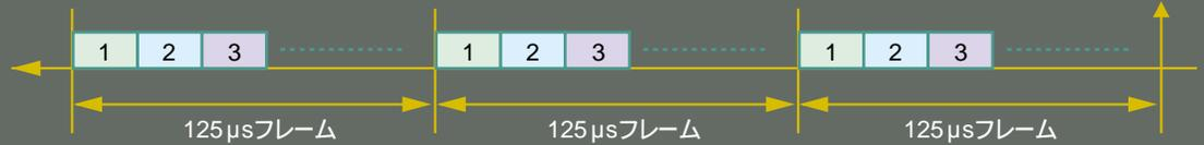
フレーム内のタイムスロットの位置によりパス、チャンネルを識別( 時間位置多重 )
