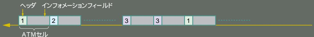
各ATMセルのヘッダによりパス( バーチャルパス )、チャンネル( バーチャルチャンネル )を識別( ラベル多重 )
