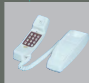
1977年 701P電話機 集積回路を用いて 小型化
