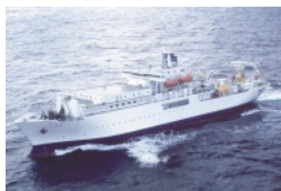
埋設船 すばる ダイナミックポジショニングの装備で定点維持が可能となり、 敷設精度が飛躍的に向上した。総トン数9,557t。
