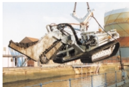
海底ケーブル埋設システム SEAMOLE 水深1,000mまでの海底でケーブルの調査と埋設を行う。砂・泥の海底ではウォータジェット、岩・礫の海底ではカッタを使用、2mの深さまで埋設。水中カメラによる調査やマニピュレータによる作業も可能。
