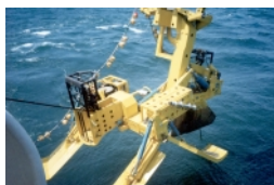
鋤式ケーブル埋設機( P-6 ) 水深1,500mまで、高速でケーブルを埋設する。
